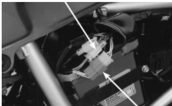
CONECTADOR 3P DEL ALTERNADOR
