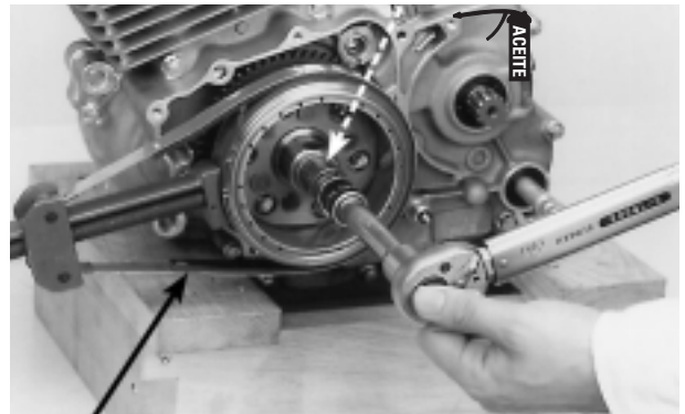
SOPORTE DEL VOLANTE DEL MOTOR
